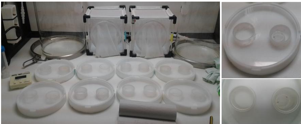
Figuur 5.2. Opstelling van acht tweekamer-olfactometers (links), met tenten voor getrainde en naïeve sluiwespes erachter. Rechts een close-up van een tweekamer-olfactometer.
